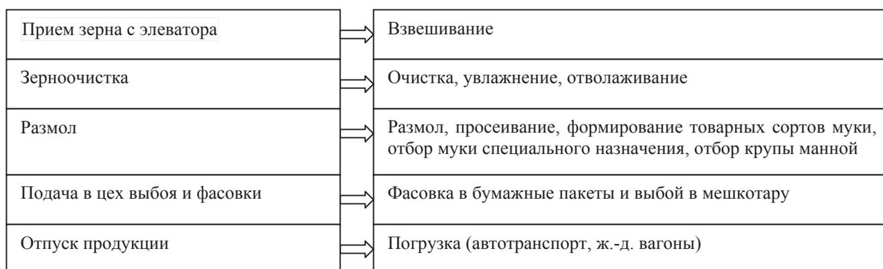
Рис. 1. Процесс мукомольного производства
