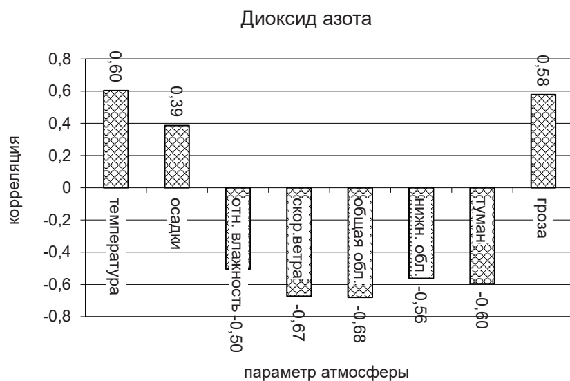
Рис. 15. Количественная характеристика связи концентрации диоксида азота с метеорологическими параметрами (числа – коэффициенты корреляции, r) [Fig. 15. Quantitative characteristics of the relationship between the concentration of nitrogen dioxide and meteorological parameters] (numbers are correlation coefficients, r)
