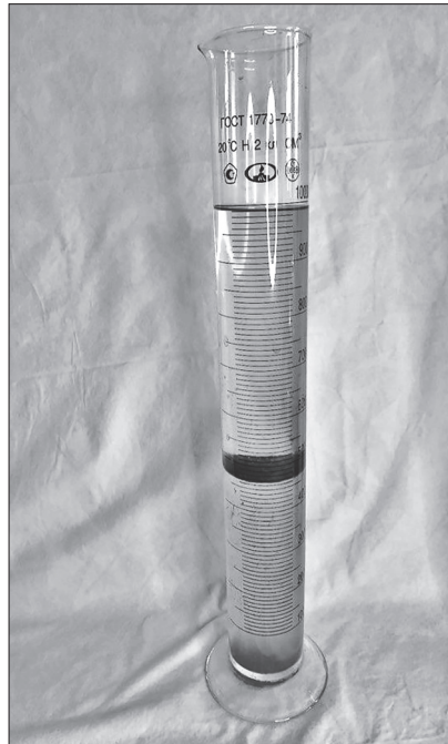
Рис. 6. Дифференциация материала нефтяной линзы (72 часа с начала эксперимента) [Fig. 6. Differentiation of the oil lens material (72 hours from the beginning of the experiment)]
