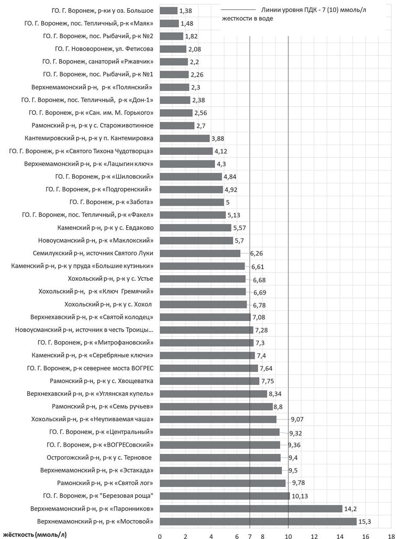
Рис. 1. Результаты анализов общей жесткости исследуемых родников по сравнению с установленными санитарно-гигиеническими показателями 1 [Fig. 1. Results of the total hardness of the springs compared to established hygiene standards 1 ]
