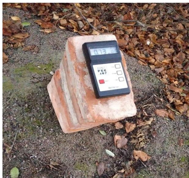
**Рис. 4.** Изучение взаимного влияния активного грунтового основания (граносиенитовая дресва) и верхнего слоя (стопка кирпича высотой 0.5м).
