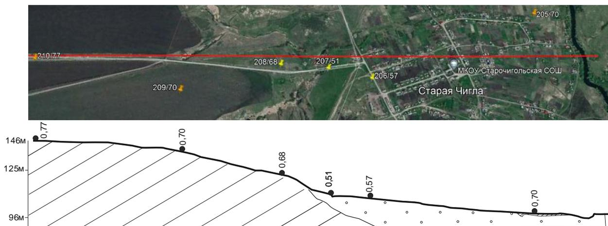
**Рис. 2.** Профиль и разрез от с. Старая Чигла до автотрассы Анна-Бобров с замерами энергии гамма-излучения. Цифровые обозначения на карте: слева номер точки наблюдения, справа - значения в МэВ; на разрезе – энергия гамма-излучения в МэВ.
