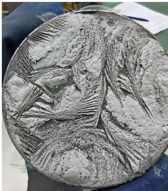
**Рис. 10.** Структура закладочного материала после промораживания.
