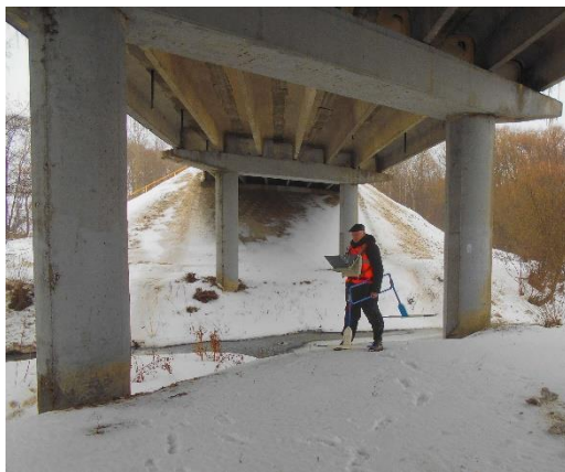
Рис. 7. Результаты георадиолокационного обследования промежуточной опоры моста на автодороге Р-298 в Саратовской обл. [Fig. 7. Results of geo-radar inspection of the intermediate bridge support on the R-298 highway in the Saratov region.]
