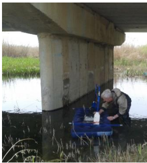
Рис. 4. Результаты георадиолокационного обследования промежуточной опоры моста на автодороге Р-239 в Оренбургской обл. [Fig. 4. Results of the geo-radar inspection of the intermediate bridge support on the R-239 highway in the Orenburg region.]
