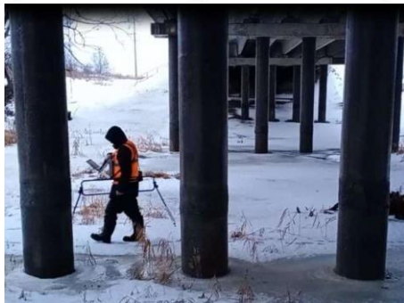
Рис. 2. Результаты георадиолокационного обследования промежуточной опоры моста на автодороге А-298 в Саратовской обл.
