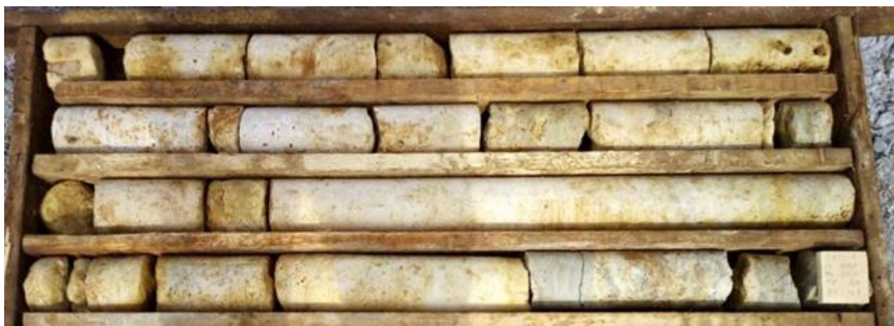
Рис. 2. Карбонатные породы удачной свиты с интервалами кавернозных коллекторов. [Fig. 2. Carbonate rocks of the Udachnaya formation with intervals of cavernous reservoirs.]
