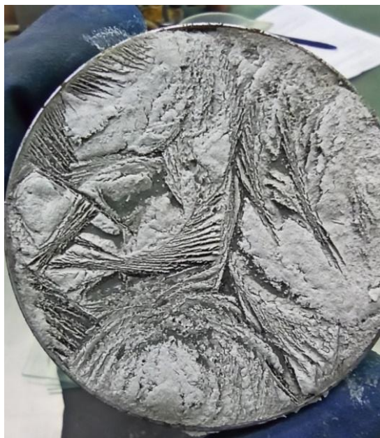
Рис. 10. Структура закладочного материала после промораживания.
