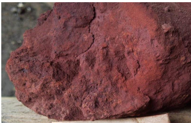
Рис. 2. БЖР Белгородского месторождения КМА. Слева мартитовая, справа гидрогематитовая руды. Из работы [6].
