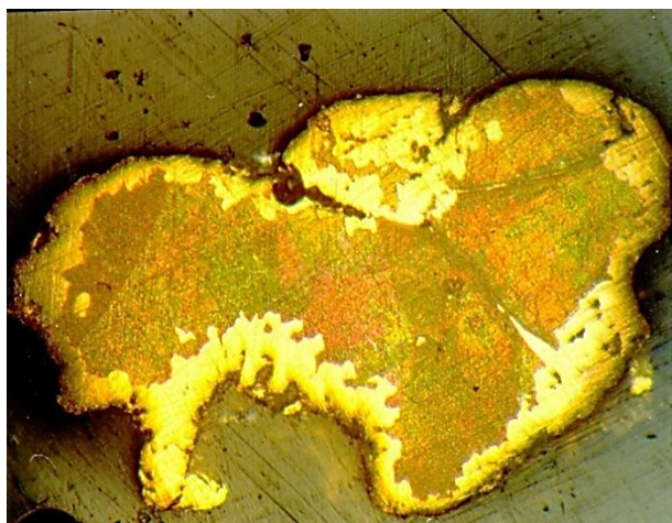
Рис. 11. Гипергенное золото из россыпи Гаран, Гвинея. Строение зерна остаточного Au с высокопробной каймой и прожилками по трещинам (увел. 150) [39].
