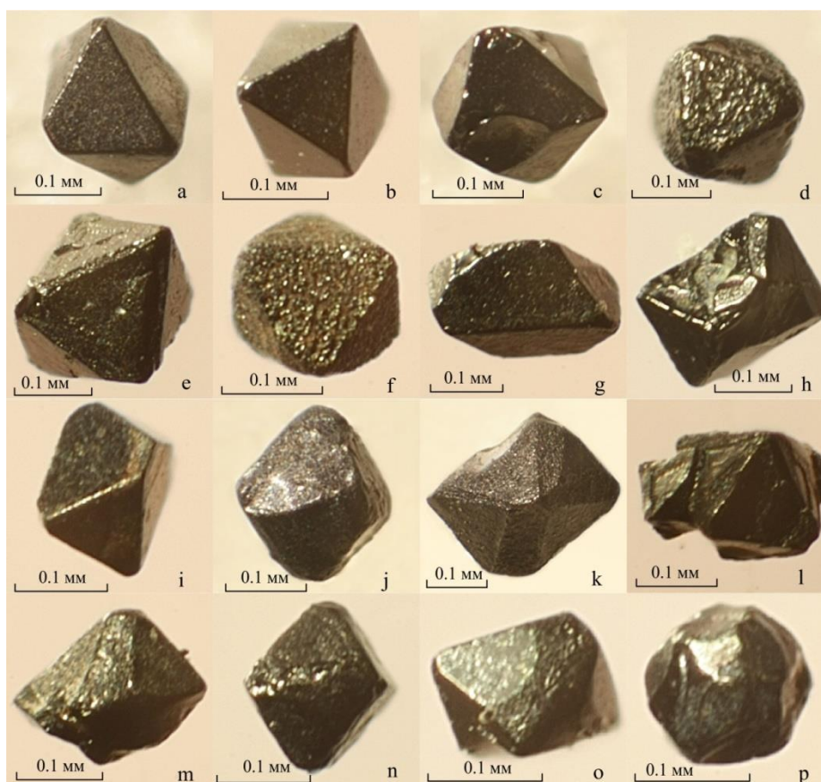
Рис. 5. Хромшпинелиды из местонаждений Лебяжье (т.н. 80) и Гремячий Колодезь (т.н. 191): a-c – октаэдрического габитуса с острыми гранями и вершинами; d-f – октаэдры со сглаженными ребрами и вершинами; g-j – искаженные кристаллы; k – октаэдр с гранями ромбододекаэдра; l – сростки кристаллов; m-o – кристаллы с вициналями; p – комбинационный кристалл.
