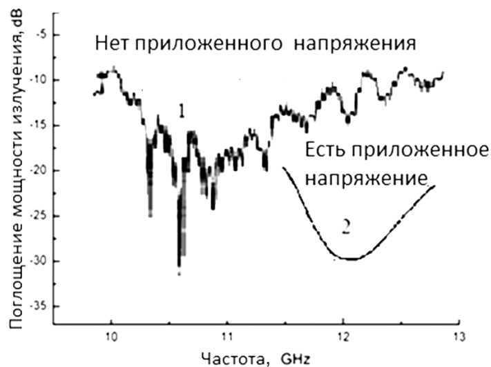
Рис. 2. 1 – средние поглощающие способности экрана, содержащего микропровода с ЕФМР в микроволновых частотах в пределах 10–12 ГГц для микропроводов из Fe_{68}C_4B_{16}Si_{10}Mn_2 ( R_m \sim 5 мкм, x \sim 5 ); 2 – гипотетическая кривая поглощения в случае внешнего давления
