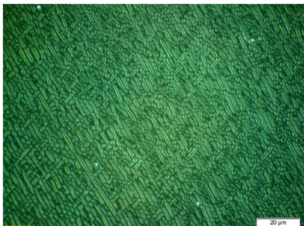
Рис. 6. Микрофотография образца ниобата лития после ПО (175 °С, 6 ч) и отжига (370 °С, 2 ч)
