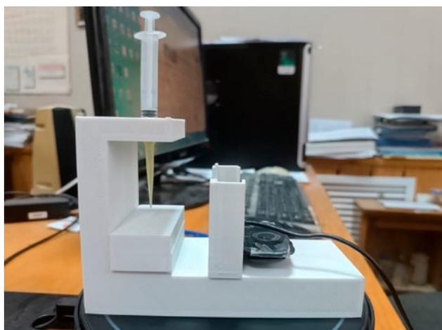
**Рис. 2.** Установка для измерения краевых углов смачивания
