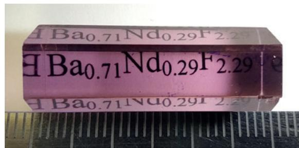
Рис. 9. Монокристалл Ba<sub>0.71</sub>Nd<sub>0.29</sub>F<sub>2.29</sub> – оптический фильтр на длину волны 2.5 мкм. Огранка искусственная. Выращен Т. Туркиной [54]. Снято 22 января 2024 г.
