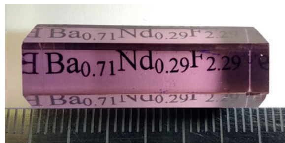
Рис. 9. Монокристалл Ba 0.71 Nd 0.29 F 2.29 – оптический фильтр на длину волны 2.5 мкм. Огранка искусственная. Выращен Т. Туркиной [54]. Снято 22 января 2024 г.
