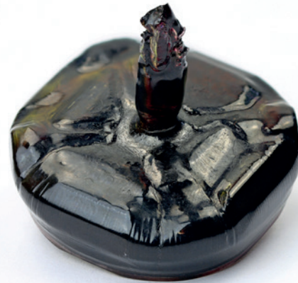
Рис. 4. Фотография кристалла \text{NaBa}_{12}(\text{BO}_3)_7\text{F}_4 ( P4_2bc ), 28 \times 28 \times 11 мм, выращенного в системе \text{Na, Ba, B // O, F} из состава 38 мол. % \text{BaO} , 13 мол. % \text{Na}_2\text{O} , 13 мол. % \text{Ba}_2\text{O}_3 , 36 мол. % \text{BaF}_2
