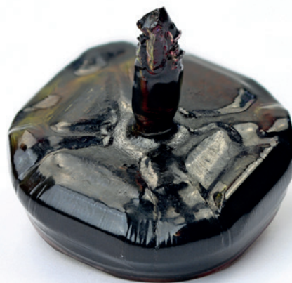
Рис. 4. Фотография кристалла \text{NaBa}_{12}(\text{BO}_3)_7\text{F}_4 ( P4_2bc ), 28 \times 28 \times 11 мм, выращенного в системе \text{Na} , \text{Ba} , \text{B} // \text{O} , \text{F} из состава 38 мол. % \text{BaO} , 13 мол. % \text{Na}_2\text{O} , 13 мол. % \text{Ba}_2\text{O}_3 , 36 мол. % \text{BaF}_2
