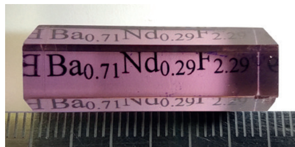
Рис. 9. Монокристалл \text{Ba}_{0.71}\text{Nd}_{0.29}\text{F}_{2.29} – оптический фильтр на длину волны 2.5 мкм. Огранка искусственная. Выращен Т. Туркиной [54]. Снято 22 января 2024 г.
