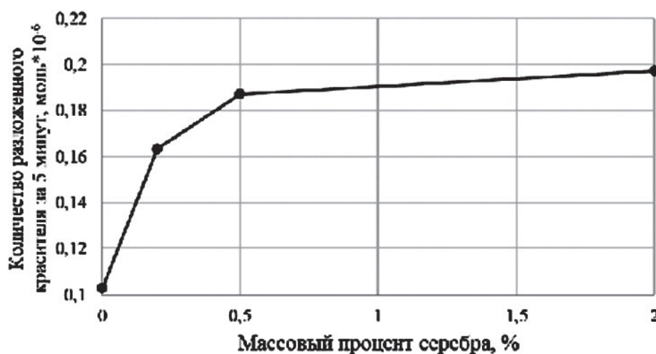
Рис. 5. График зависимости активности композита от содержания серебра
