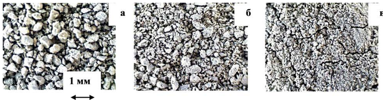
Рис. 1. Изображения поверхностей полидисперсной системы А: исходный образец (а), 10 минут (б) и 20 минут (в) воздействия СВЧ-излучения
