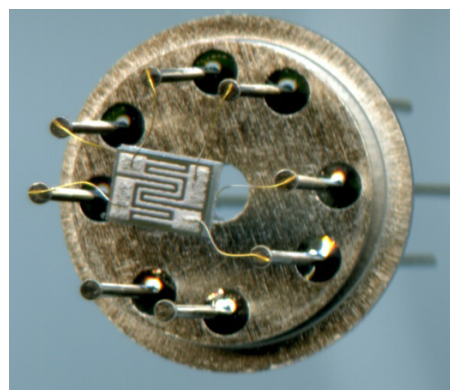
Рис. 1. Тестовая структура для исследования электрофизических и газосенсорных свойств PdO пленок
