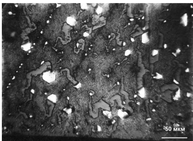
Рис. 1. Диссоциация фосфида индия на поверхности пластины
