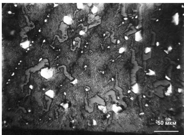
Рис. 1. Диссоциация фосфида индия на поверхности пластины
