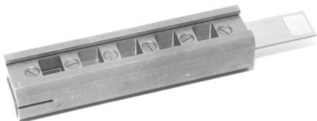
Рис. 2. Графитовая кассета для выращивания слоев в InP/InGaAsP на подложках InP
