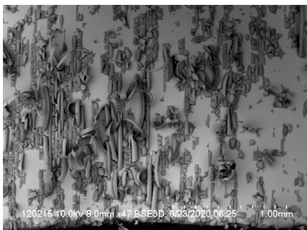
Рис. 6. Микрофотография поверхности Mn_5Ge_3 после анодной поляризации при E = +0.6 В в 0.5 М растворе Na_2SO_4 в течение 10 минут
