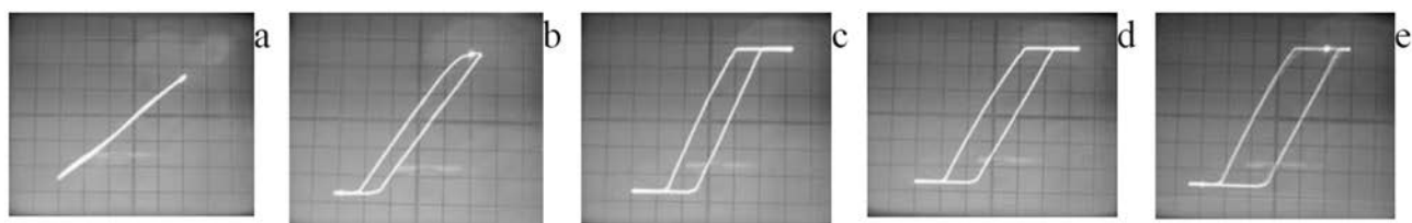
Рис. 7. Петли сегнетоэлектрического гистерезиса для образца \text{Co}_{32}\text{Ge}_{33}\text{Te}_{35} : a) 50 Hz; b) 500 Hz; c) 1.0 kHz; d) 1.1 kHz; e) 1.2 kHz
