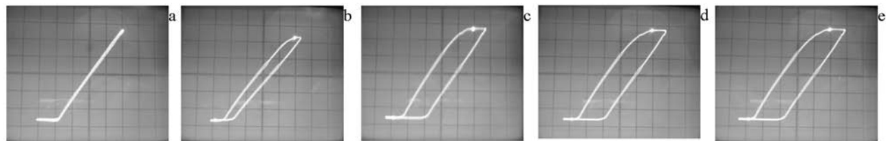
Рис. 9. Петля сегнетоэлектрического гистерезиса для образца GeTe: a) 50 Hz; b) 500 Hz; c) 1.0 kHz; d) 1.1 kHz; e) 1.2 kHz
