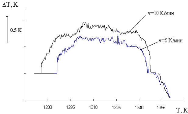
Рис. 1. Кривые ДТА переходных процессов предплавления Cu в различных динамических режимах
