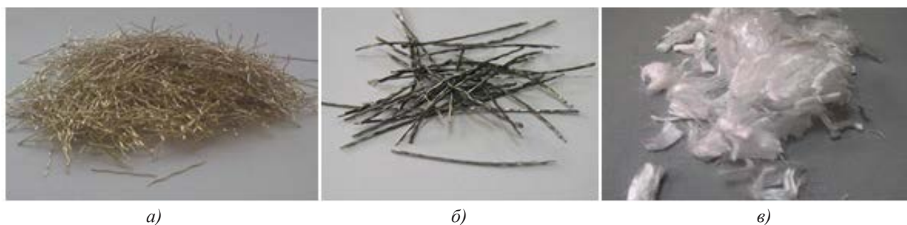
Рис. 1. Фибра, используемая для армирования каутона: а — стальная рубленая l = 40 мм, d = 0.8 мм; б — стальная латунированная l = 15 мм, d = 0,3 мм; в — полипропиленовая фибра l = 12 мм, d = 12 мкм.
