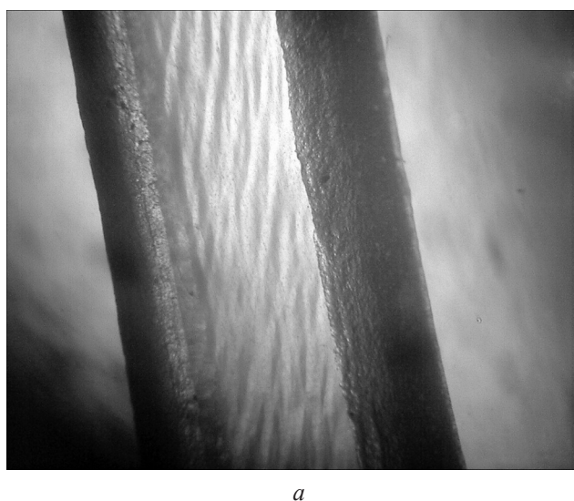
Рис. 7. Фотографии полированных кристаллов Va_{1-x}Dy_xF_{2+x} с ячейистой субструктурой (диаметр кристалла 10 мм): а — x = 0.139 \pm 0.006 ; б — x = 0.157 \pm 0.006 ; температурный градиент — 125 K/см; скорость протяжки — 11 мм/час
