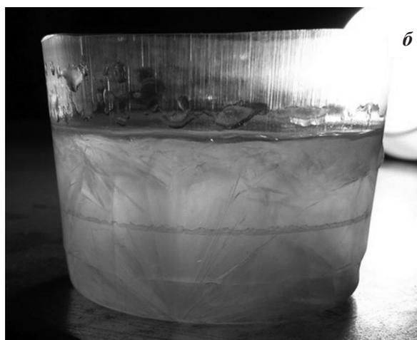
**Рис. 1.** Фотография слитка льда, сформированного в 20 % водном растворе изопропилового спирта: а — вид сверху; б — вид сбоку.
