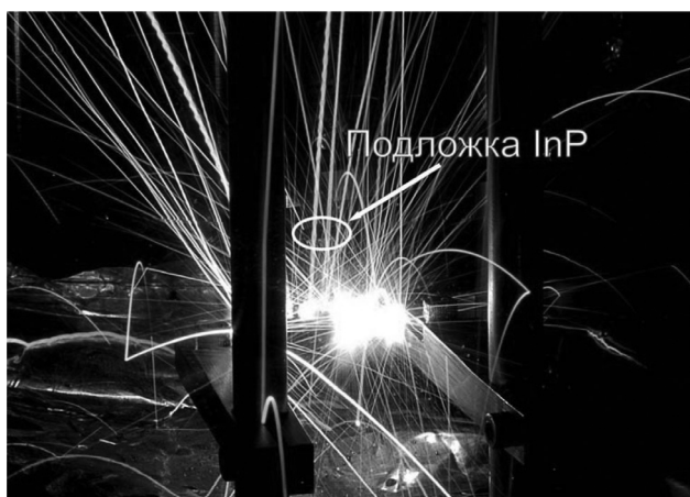
Рис. 3. Фотография электровзрыва платинового проводника с латеральным направлением съёмки ( 10^{-1} мм. рт.ст).
