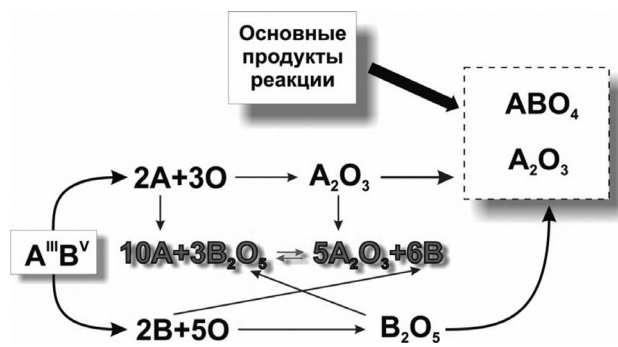
Рис. 1. Схема реакций, протекающих при собственном окислении полупроводников типа A^{III}B^V .
