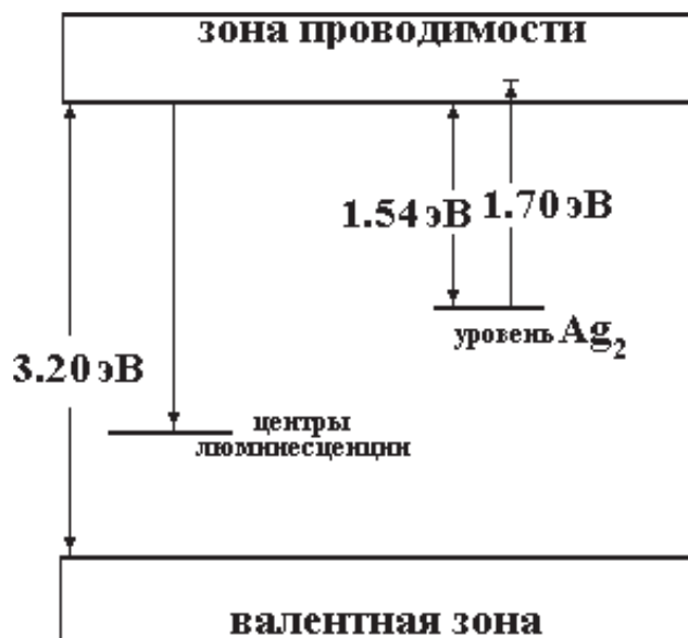
Рис. 3. Зонная диаграмма энергетических состояний, связанных с адсорбированными на поверхности монокристалла AgCl димерами серебра Ag_2
