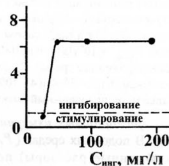
Рис. 6. Влияние концентрации смеси ЭМ9 на диффузию водорода через стальную (Ст.3) мембрану из растворов, содержащих 50 г/л NaCl, при \text{pH} = 4 . Концентрация \text{H}_2\text{S} , мг/л: а – 25; б – 100. i_0 (поток диффузии в неингибированных растворах), \text{А/м}^2 : а – 0,128; б – 0,219 при E_{кор} входной стороны мембраны. Комнатная температура, атмосфера – воздух.
