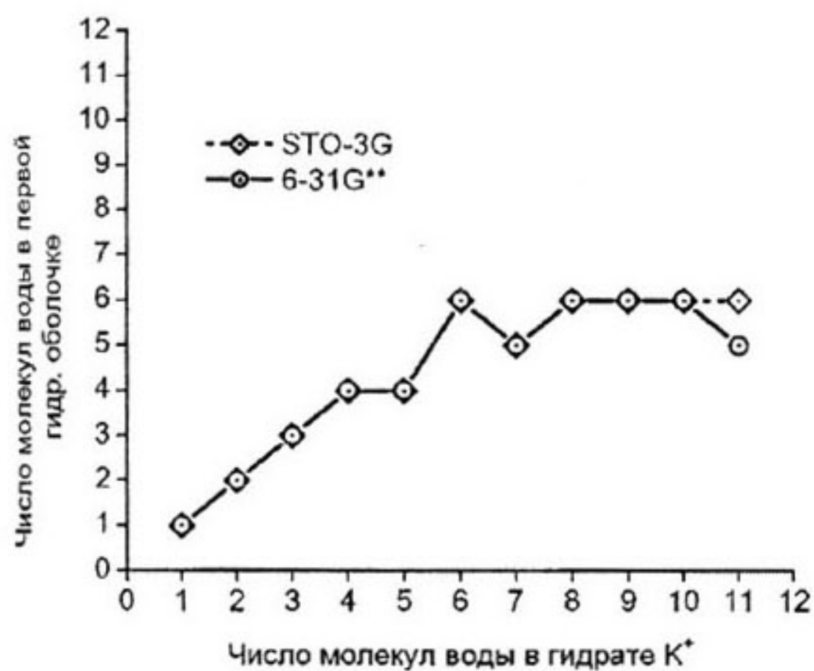
Рис. 2. Зависимость числа молекул воды в первой гидратной оболочке от общего количества молекул воды в гидрате.
