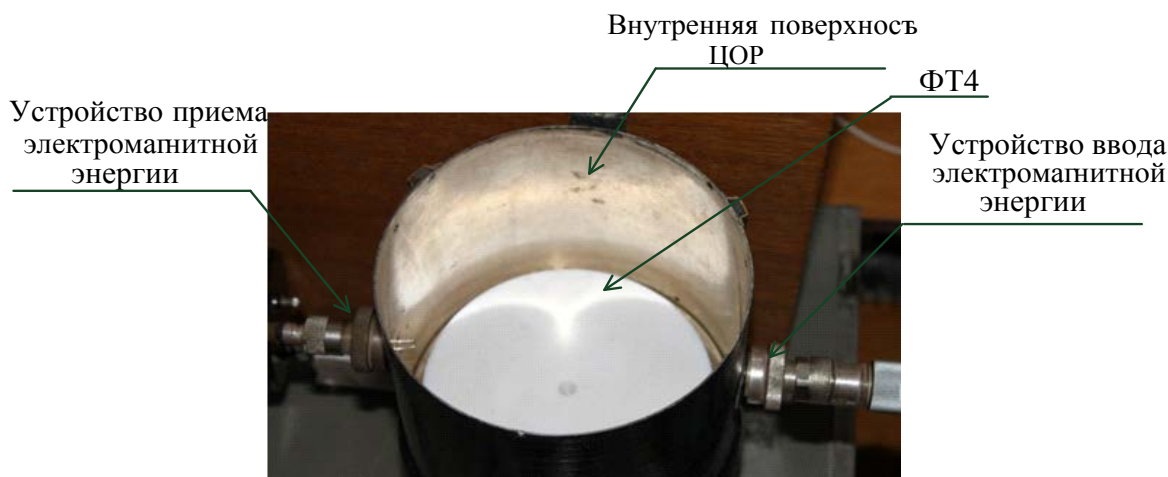
Рис. 3. Внешний вид внутренней полости ЦОР с возмущающим концентрирующим диэлектриком
