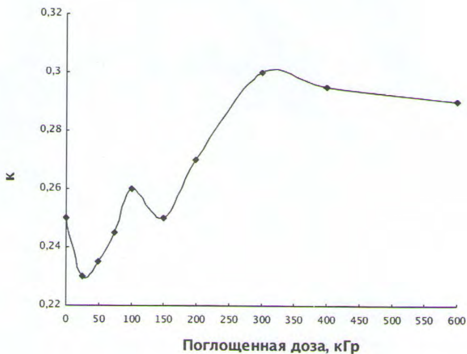
Рис. 3. Зависимость коэффициента механических потерь при 24 °С композиций на основе ПВА от поглощенной дозы при электронно-лучевой обработке графитного наполнителя
