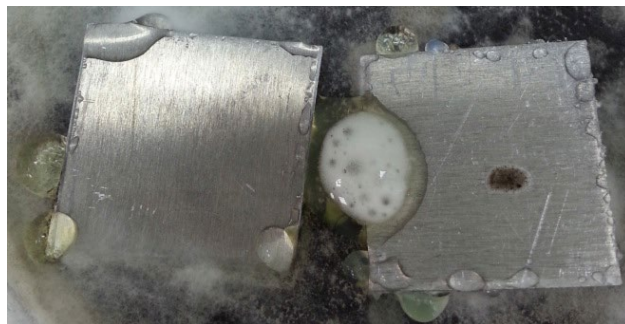
Рис. 9. Образование водорода, образующегося при взаимодействии экссудата со сплавом Д16Т в местах его контакта с газом мицелия микромицетов
