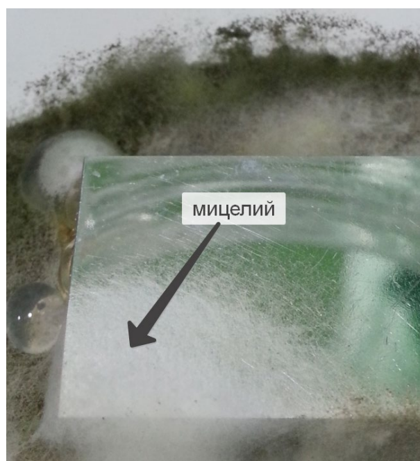
Рис. 6. Адгезия мицелия микромицетов на поверхности образцов и их постепенное обрастание (показано стрелками)
