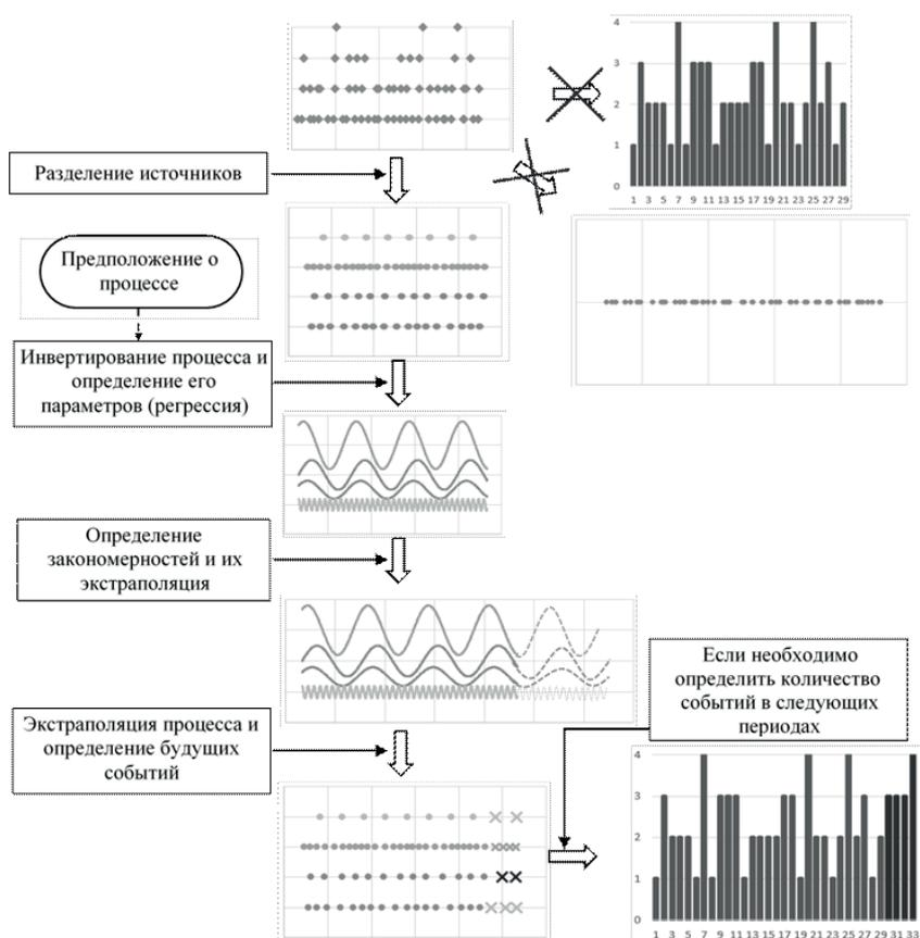
Рис. 1. Схема анализа и прогнозирования редких событий
