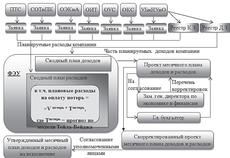
Рис. 3. Схема процесса внутрифирменного бюджетирования с корректировкой расчета расходов на оплату потерь электроэнергии на примере ТСО ОАО «ВОЭ»
