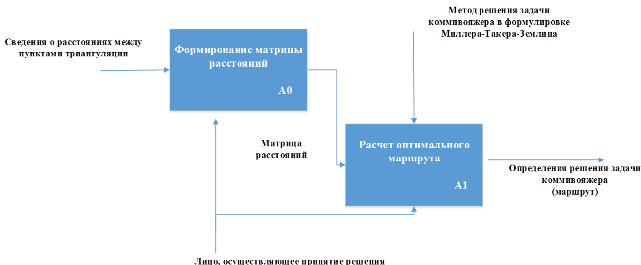
Рис. 4. Разработанный алгоритм поиска оптимального маршрута между пунктами триангуляции в виде диаграммы IDEF0
