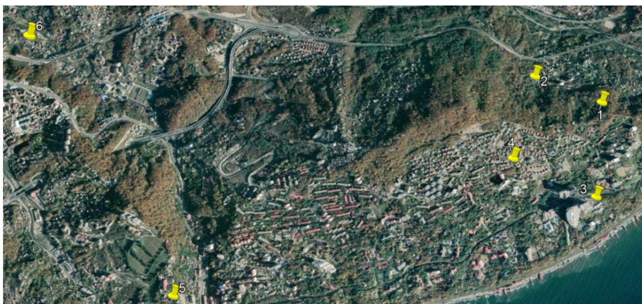
Рис. 1. Схема расположения GNSS-приемников при выполнении статических измерений вблизи горы Ахун
