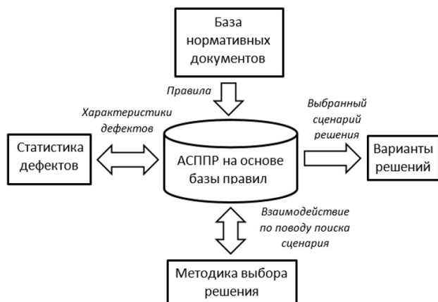
Рис. 2. Схема принятия решения в ситуации анализа причины дефекта на основе правил [Fig. 2. Schema of decision making in the situation of rule-based analysis of the cause of a defect]
