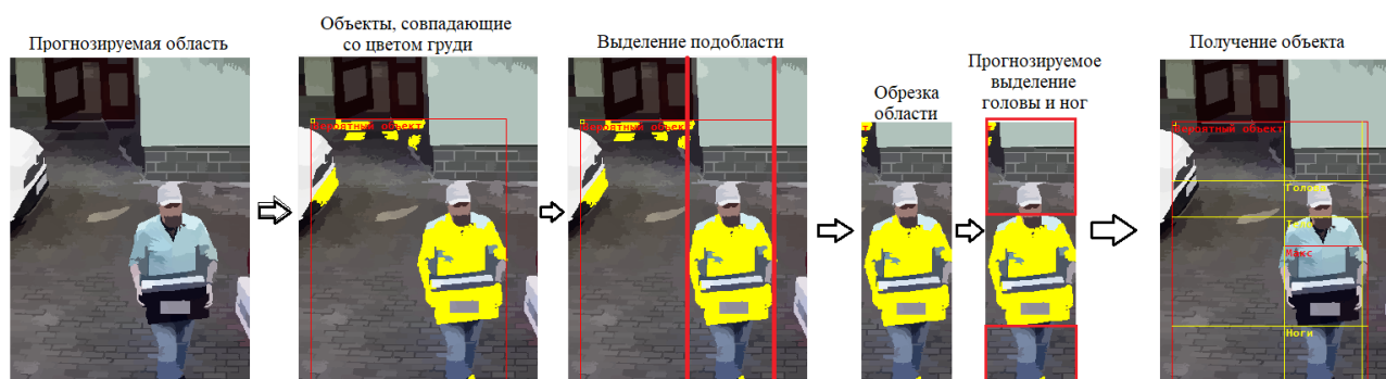
Рис. 5. Процесс поиска объекта в прогнозируемой области [Fig. 5. The process of searching for an object in the predicted area]
