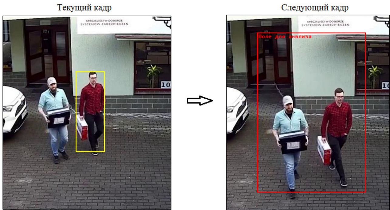
Рис. 4. Получение прогнозируемой области в зависимости от размера объекта [Fig. 4. Getting the predicted area depending on the size of the object]
