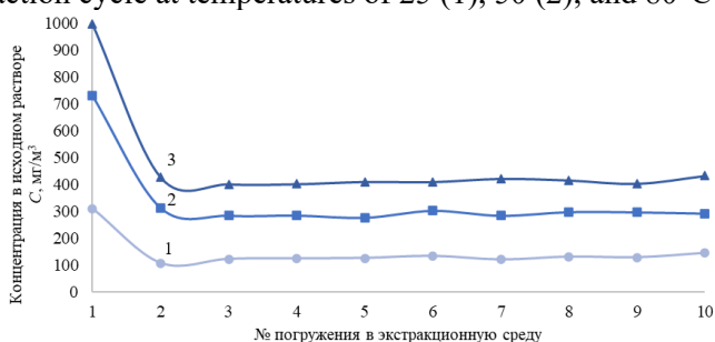
Рис 3. Зависимость концентрации гексадекановой кислоты в n -октаноле от цикла статической экстракции при температурах 25 (1), 50 (2) и 80°C (3)
