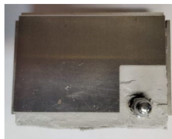
Рис. 2. Фотография планарной газохроматографической колонки с термоизоляцией Fig. 2. Photograph of a planar gas chromatographic column with heat insulation
