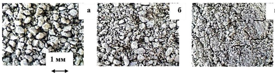
Рис. 2. Изображения поверхностей частиц глины в исходном состоянии (а), после 10 минут (б) и 20 минут (в) воздействия СВЧ-излучения
