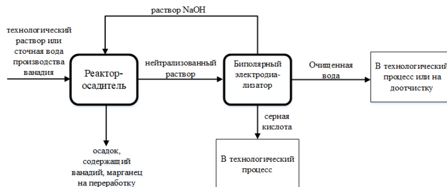
Рис. 6. Безреагентная электромембранная схема переработки кислотных сточных вод производства ванадия
