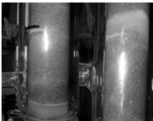
Рис. 8. Начальная и конечная стадии процесса осаждения в слое ионита в фосфатной форме при пропускании горячей ЭФК через колонку по методике стандартного AR-процесса.
