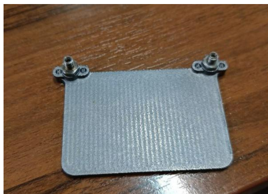
Рис. 2. Планарная микрофлюидная хроматографическая колонка, длина канала – 1 метр, сечение канала – 1×1 мм. Производство ООО «НПФ МЭМС», г. Самара.
