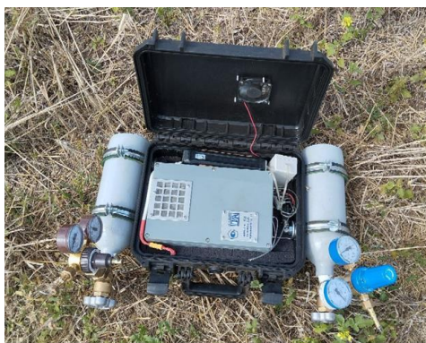
Рис. 2. Мобильный аналитический комплекс на базе портативного хроматографа «ПИА» производства ООО «НПФ МЭМС», г. Самара.
