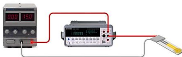
Рис. 1. Установка для определения антибиотиков в жидкостях амперометрическим сенсором Fig. 1. Installation for determination of antibiotics in liquids using an amperometric sensor
